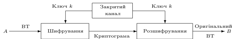
Рис. 3.1.2. Шифрування і розшифрування VT з одним ключем
