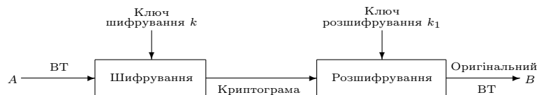
Рис. 3.1.3. Шифрування і розшифрування VT з двома різними ключами
