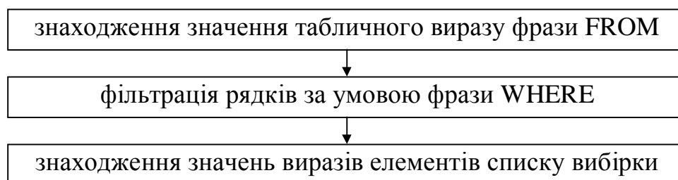
Рис. 2.2. Схема інтерпретації запитів без групування, які використовують агрегатні функції
