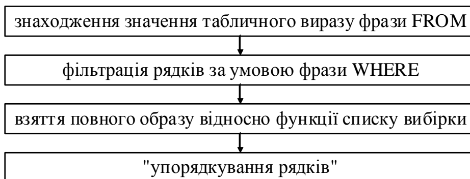
Рис. 2.1. Схема інтерпретації запитів, які не використовують агрегатні функції та групування
